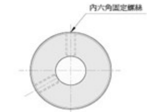
圖一 固定螺絲式 Set screw type
